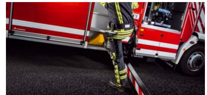
/ Wenn es eng zugeht, ist ein einfaches Übersteigen der Abstützbalken möglich.
