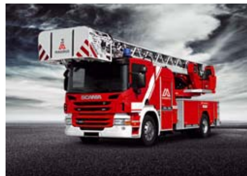
/ Magirus-Drehleiter auf Scania-Fahrgestell
