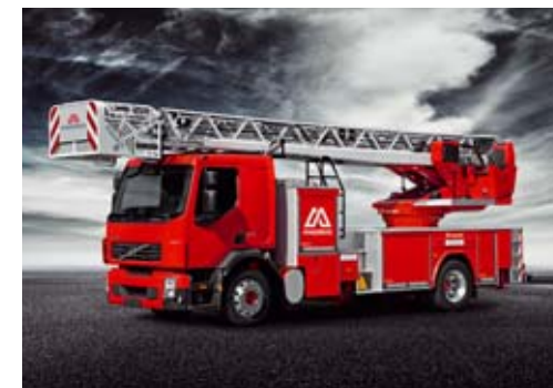
/ Magirus-Drehleiter auf Volvo-Fahrgestell
