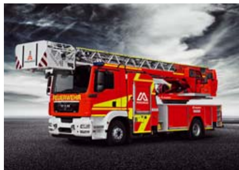
/ Magirus-Drehleiter auf MAN-Fahrgestell
