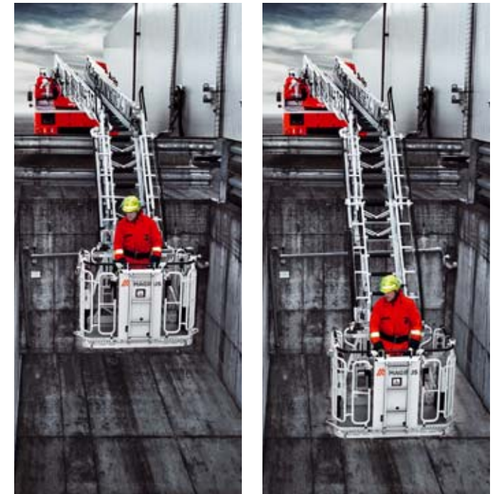
/ Eindringtiefe einer Gelenkarm-Drehleiter und einer Gelenkarm-Drehleiter mit Teleskop im Vergleich (v.l.).
