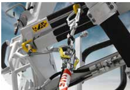
Adapter Leiterspitze: Bis 500 kg können schnell und einfach bewegt werden.
