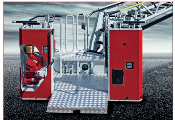
Neu entwickelter Rettungs- und Arbeitskorb RC500-H
