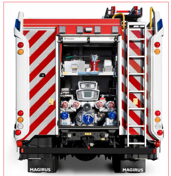
Leicht zugängliche Pumpe mit intuitiver HMI-Bedieneinheit
